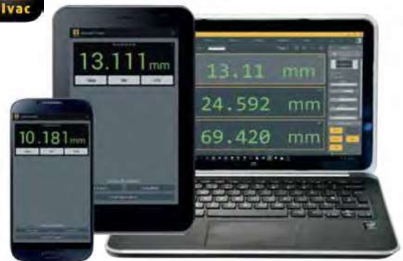
La app SylvacBT Smart permite la comunicación con los instrumentos Bowers Bluetooth (Android 8.0 IOS 10)
