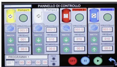
Funzionamento pompe Pumps operation display
