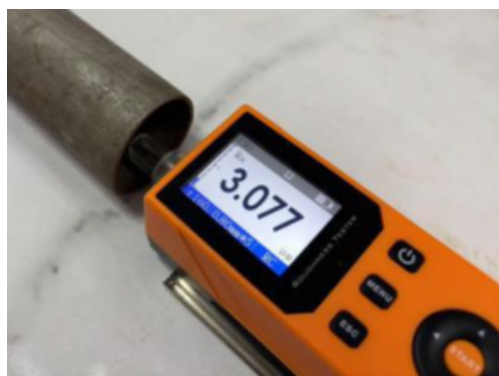
Medición del interior de un tubo
